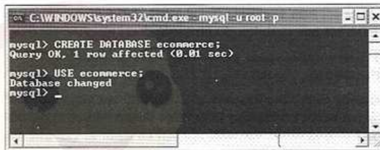
Hình 8-15: Bước đầu tiên là tạo và chọn cơ sở dữ liệu mới.
