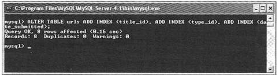
Hình 5-36: Với SQL, chúng ta có thể bổ sung nhiều chỉ mục cùng lúc.
