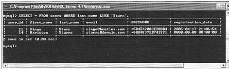
Hình 4-20: Thuật ngữ LIKE của SQL cho phép tạo các điều kiện có tính linh động cao.
